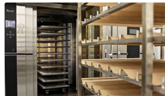
3. Установка Rotosole размещается и предварительно нагревается в печи. Все, что Вам необходимо сделать - это разместить тележки Rotosole с мягкими противнями и закрыть дверь.
